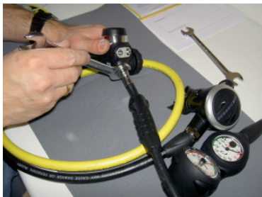
die Konsole wird montiert
