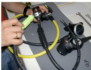
Inflatorschlauch wird montiert
