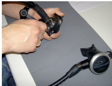
Blindstopfen werden abgeschraubt
