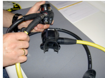
Oktopus wird montiert
