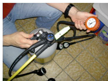
AR wird an die Flasche angeschlossen u. der Mitteldruck überprüft
